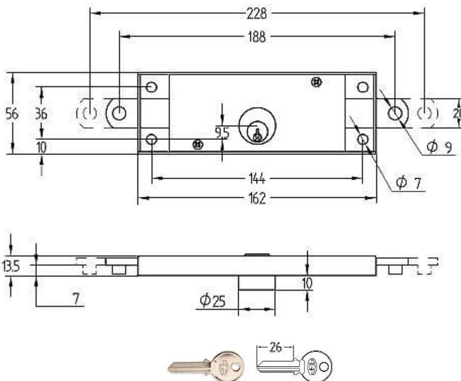
Boîtier et mécanisme en acier zingué,
